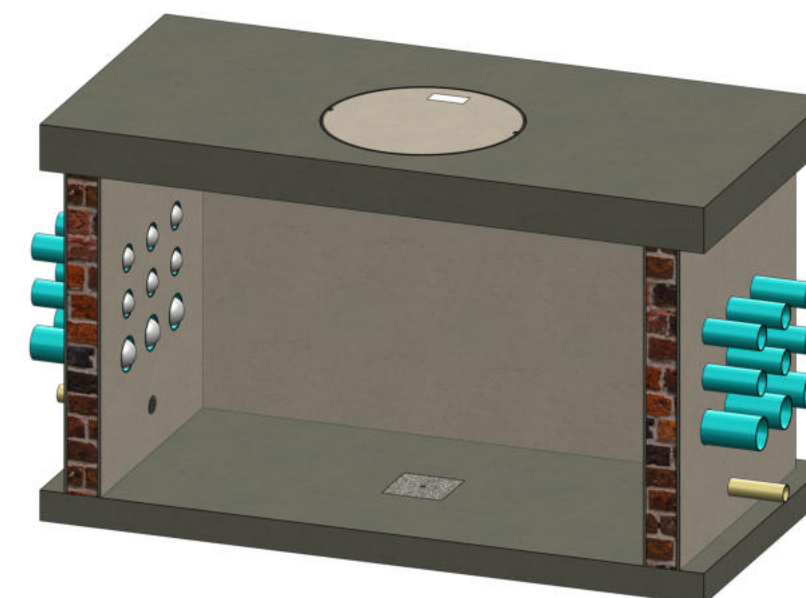
Figura 36. Caja de Inspección Doble para Media Tensión 13.2 kV Tipo Vehicular.
