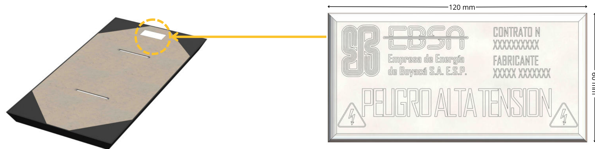
Figura 8. Detalles de placas de advertencia.
