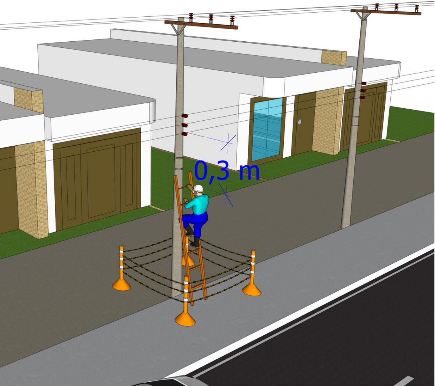
Figura 8. Distancias mínimas para trabajos en o cerca de partes energizadas.
