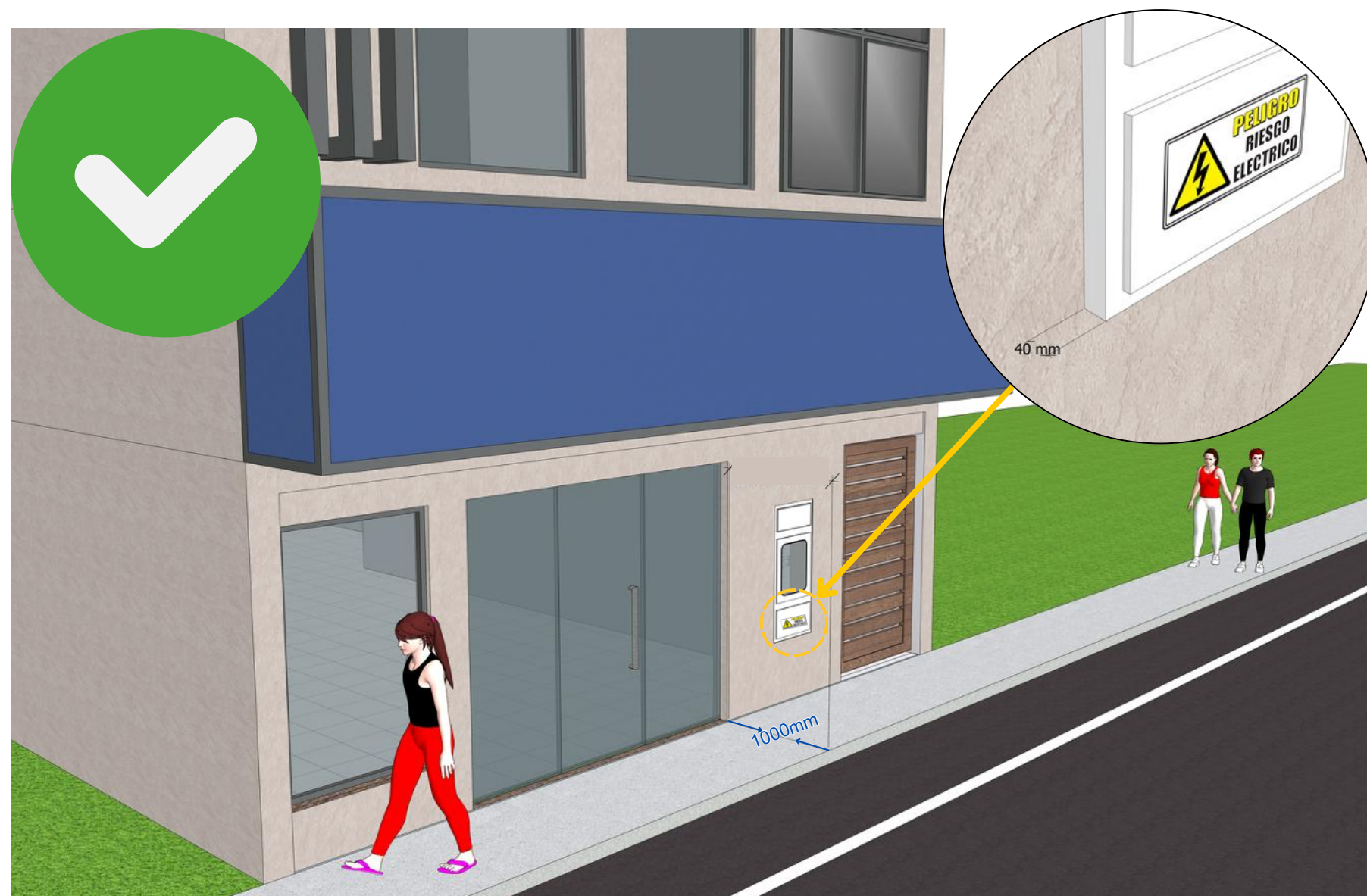
Figura 1. Criterios de instalación y sobresaliente permitido de gabinetes de medición en muros según tipo de material y ancho del andén.
