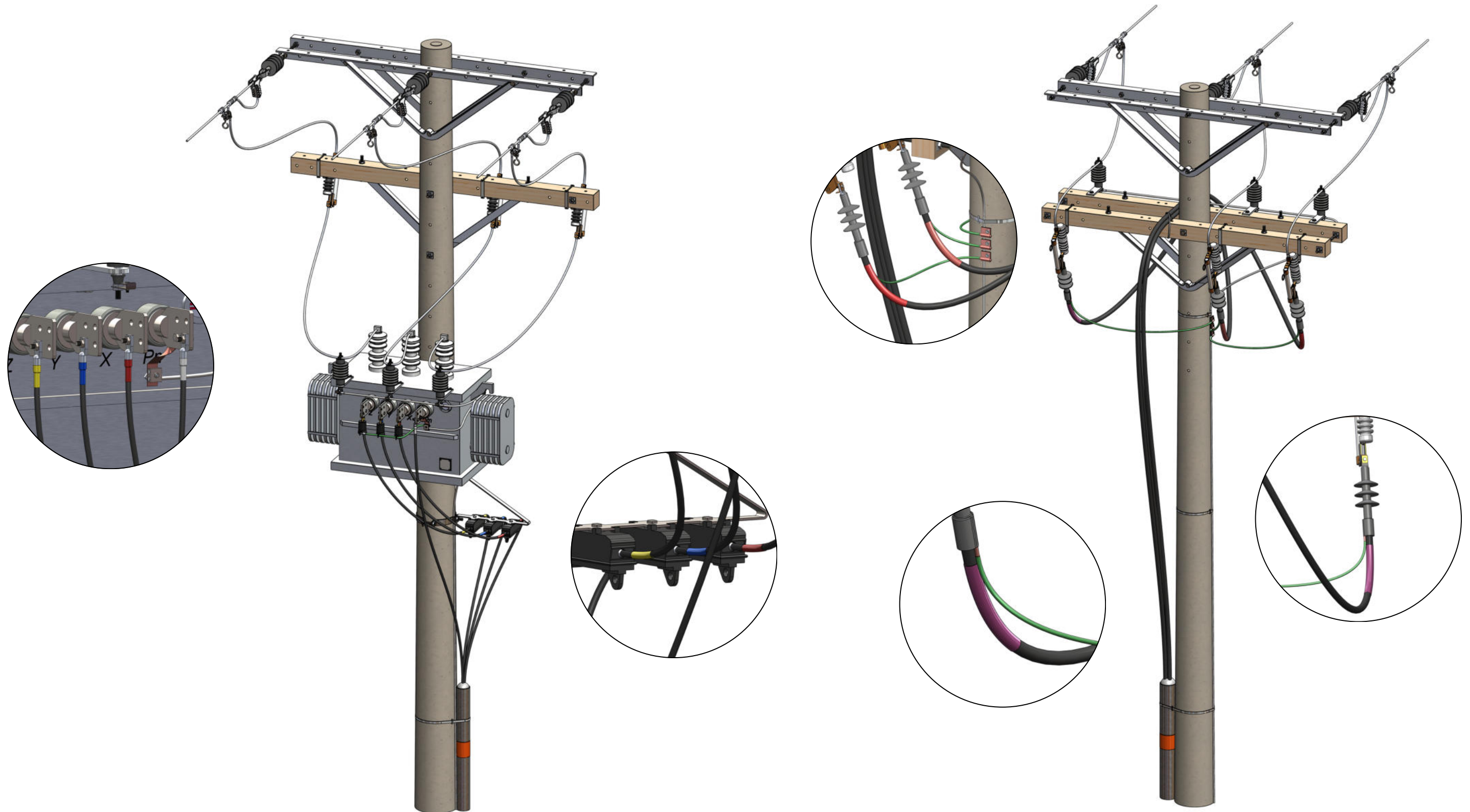
Figura 11. Identificación del nivel de tensión y código de colores en conexiones de media y baja tensión.
