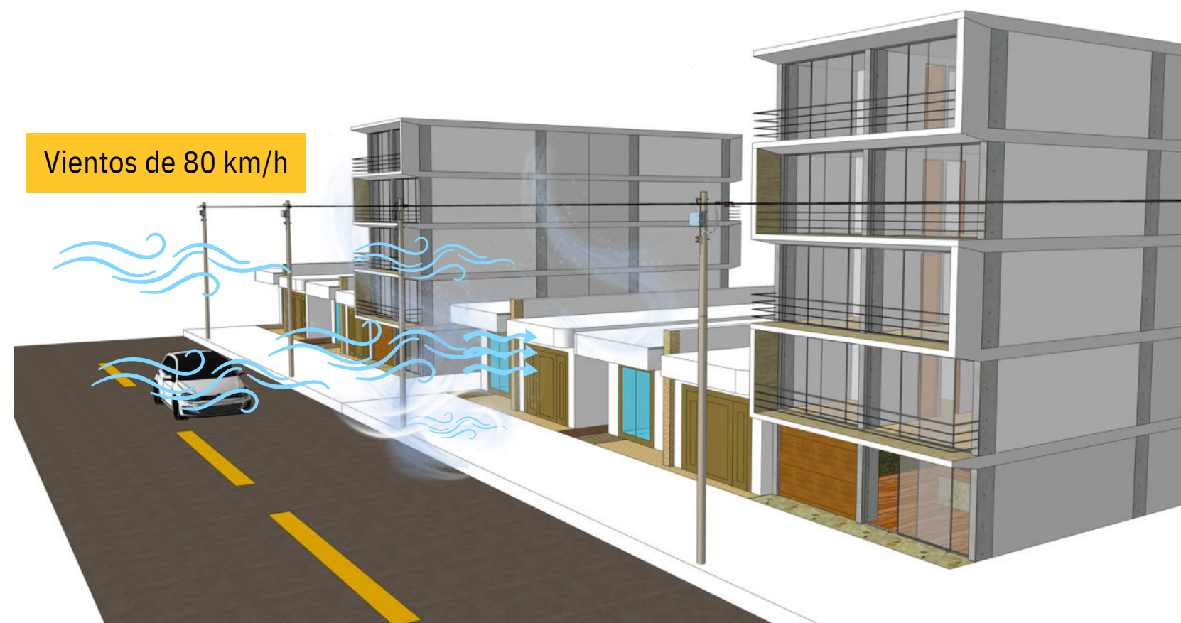
Figura29. Efecto del Viento sobre Red de BT en Zona Urbana.
