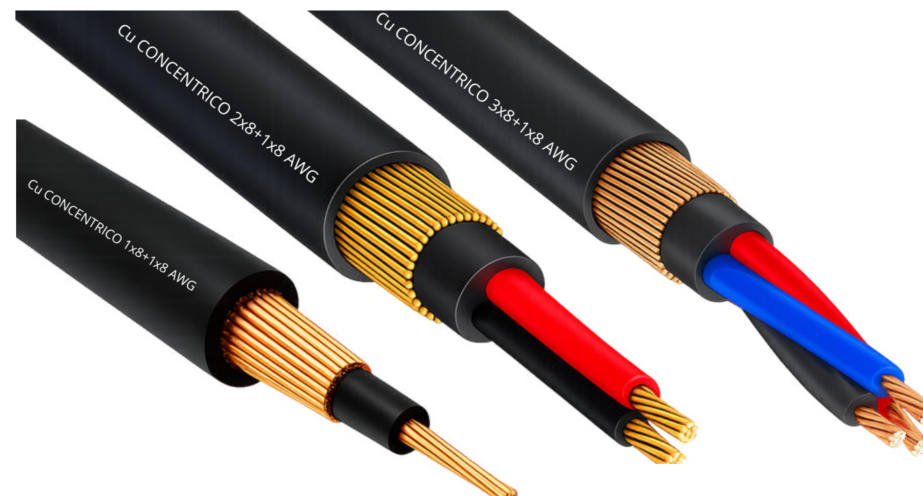
Figura 8. Cable concéntrico de cobre para acometida (desde red secundaria hacia equipos de conexión, o de medida o interruptor de servicio).
