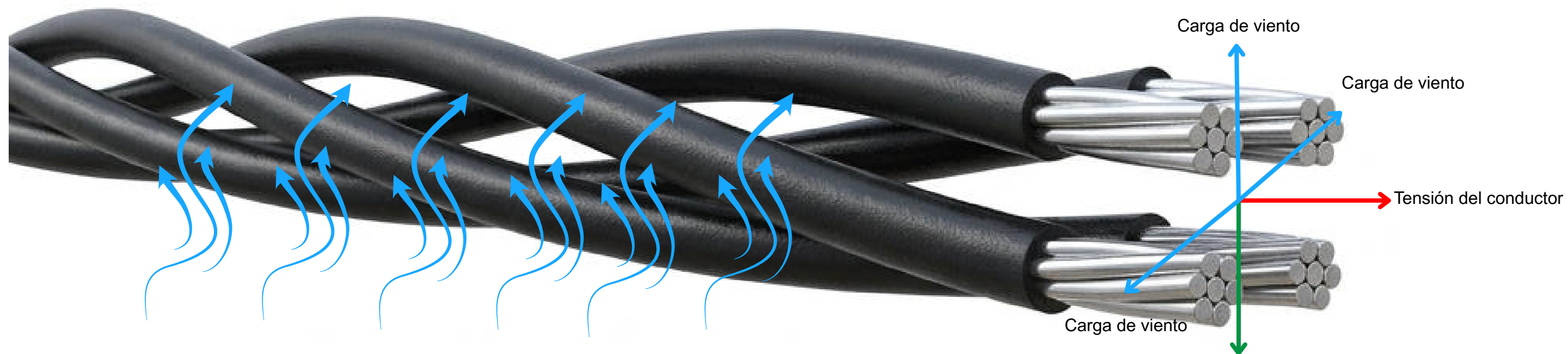
Figura 30. Composición Vectorial de Cargas: Peso + Viento = Resultante.
