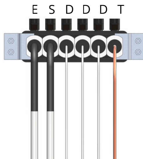
Figura 4. Configuración barraje de neutro en baja tensión.
