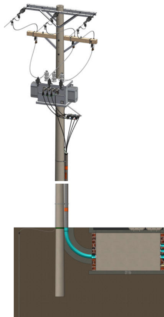
Figura 37. Transición red baja tensión aéreo - subterráneo desde bornes de transformador TR-2006.
