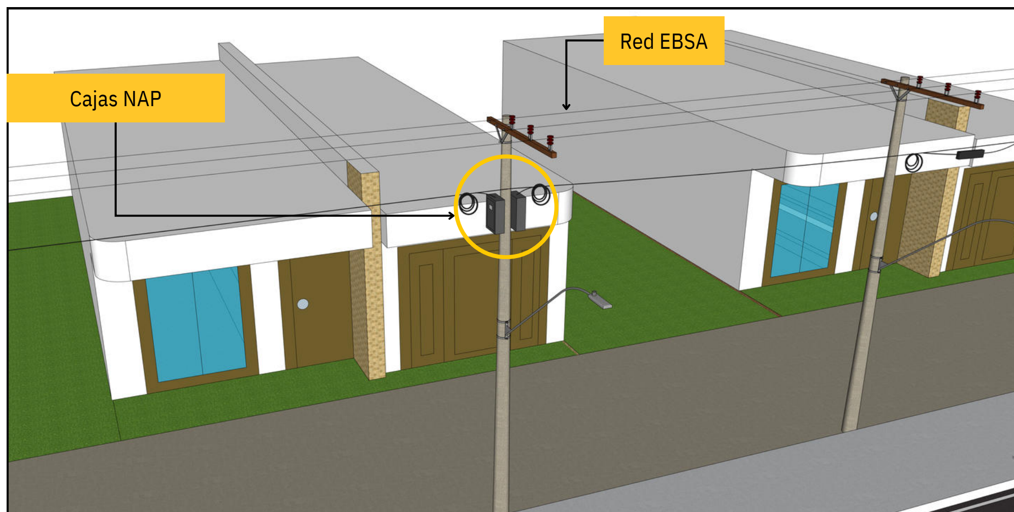
Figura 9. Ubicación de cajas NAP en red compartida con infraestructura eléctrica de EBSA
