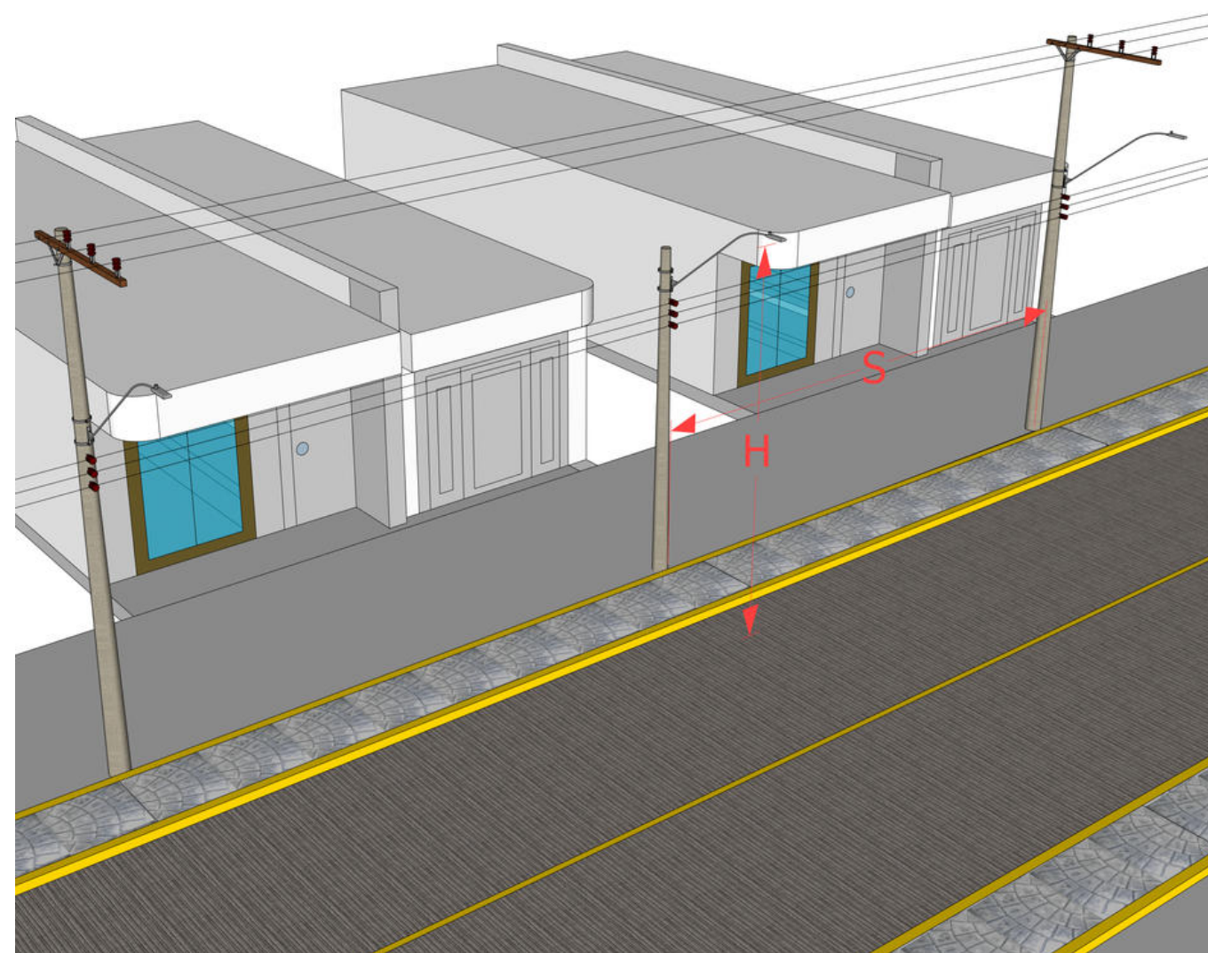
Figura 1. Altura de montaje (H) e interdistancia (S) entre luminarias en postes de uso compartido con redes eléctricas en zonas urbanas.
