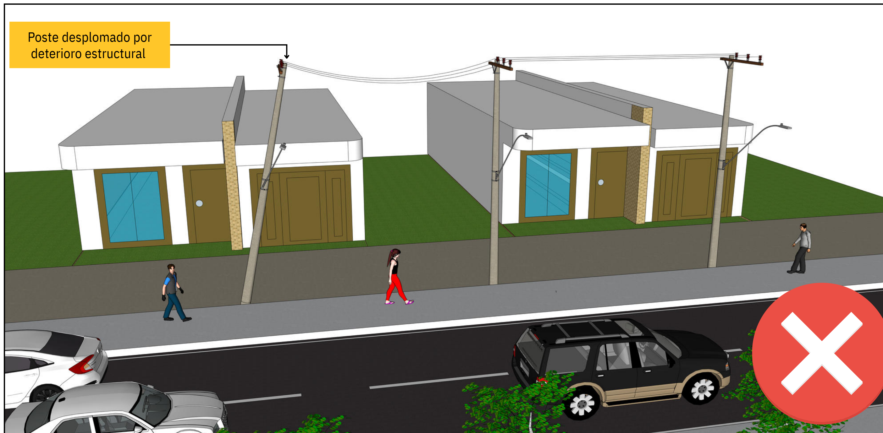
Figura 7. Ejemplo de poste desplomado por deterioro estructural en red compartida de alumbrado público y distribución eléctrica.
