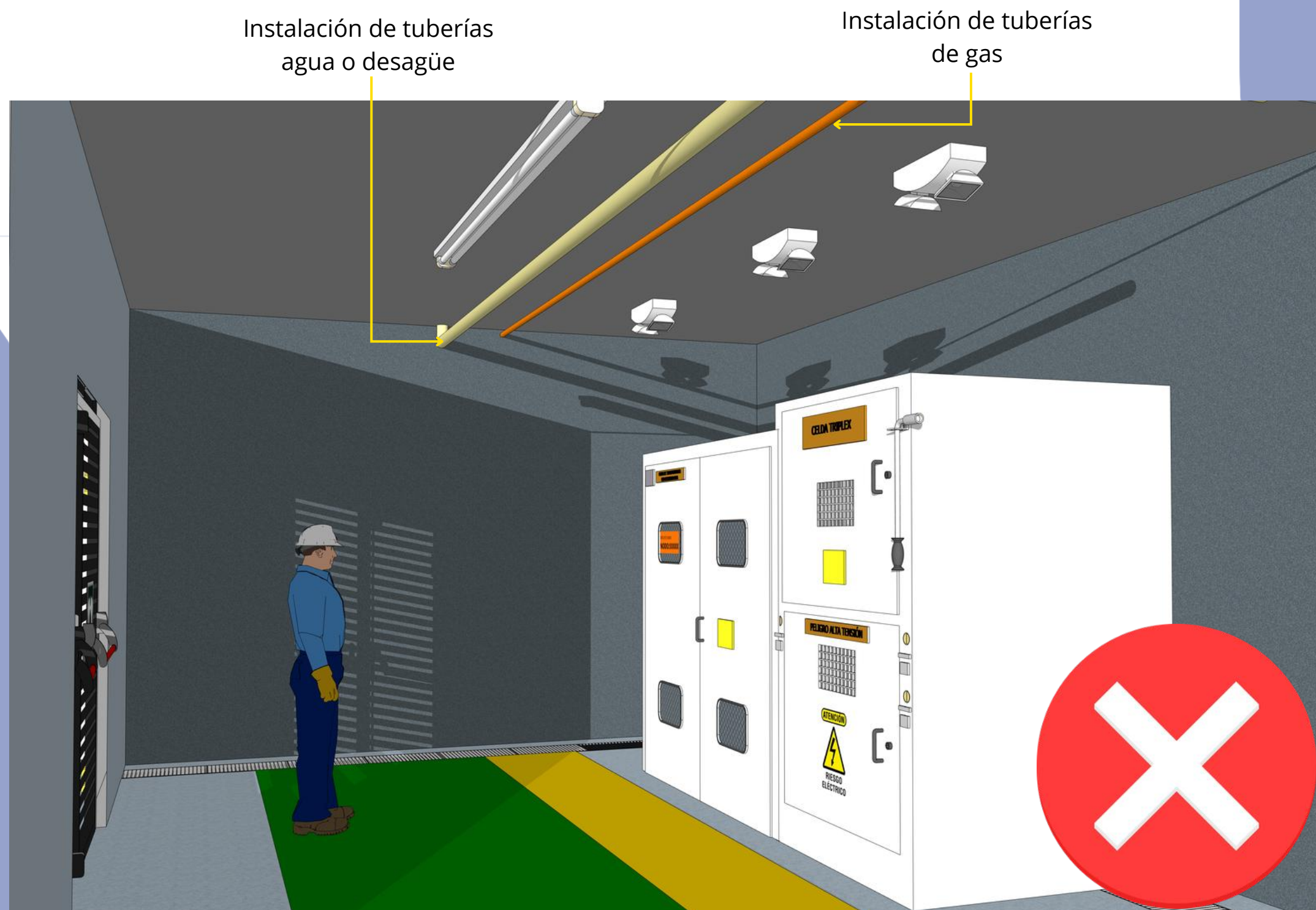
Figura 36. Prohibición: Instalación de tuberías de agua, gas o vapor.
