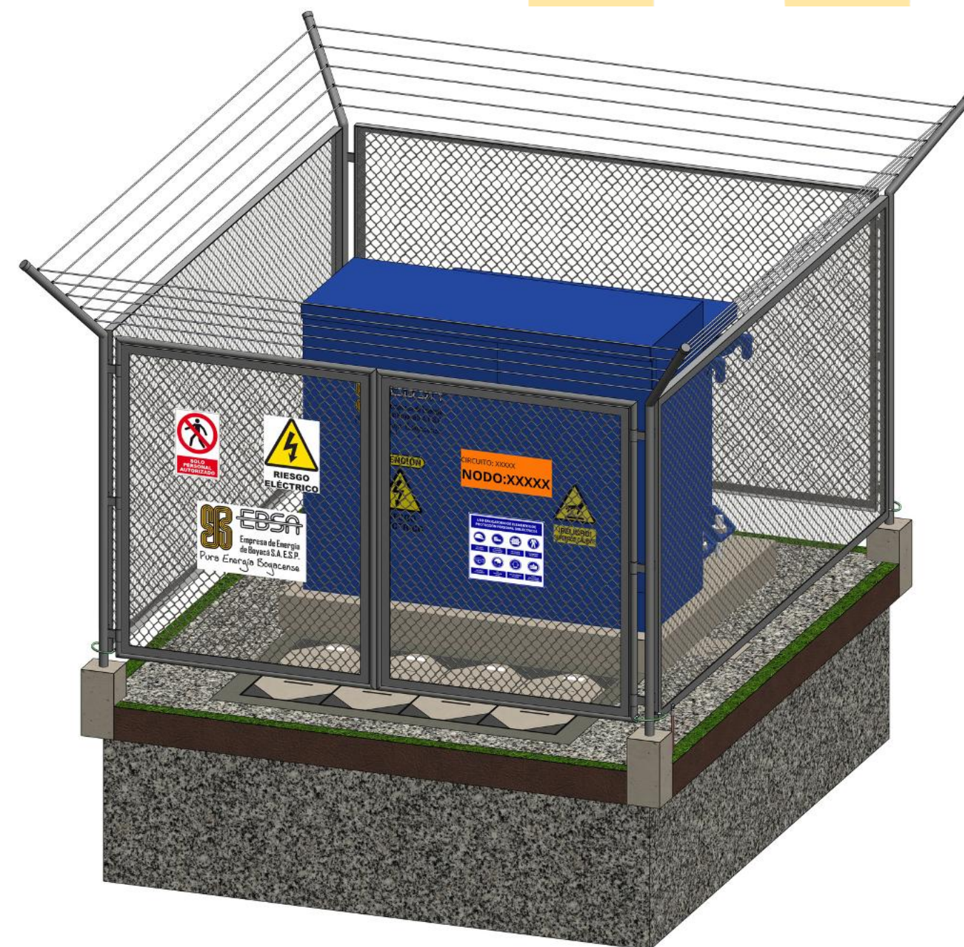
Figura 13. Encerramiento para transformador tipo pedestal.
