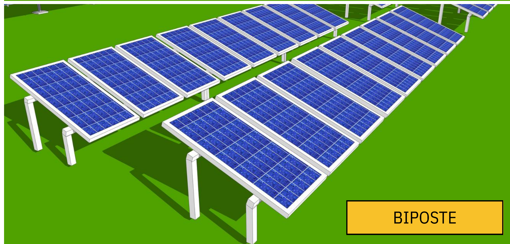
Figura 3. Tipologías de estructuras de soporte para módulos fotovoltaicos: monoposte y biposte
