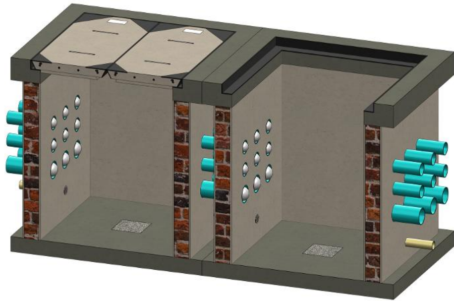
Figura 33. Caja de Inspección Sencilla para Media Tensión 13.2 kV y Caja de Comunicaciones CD-2015.
