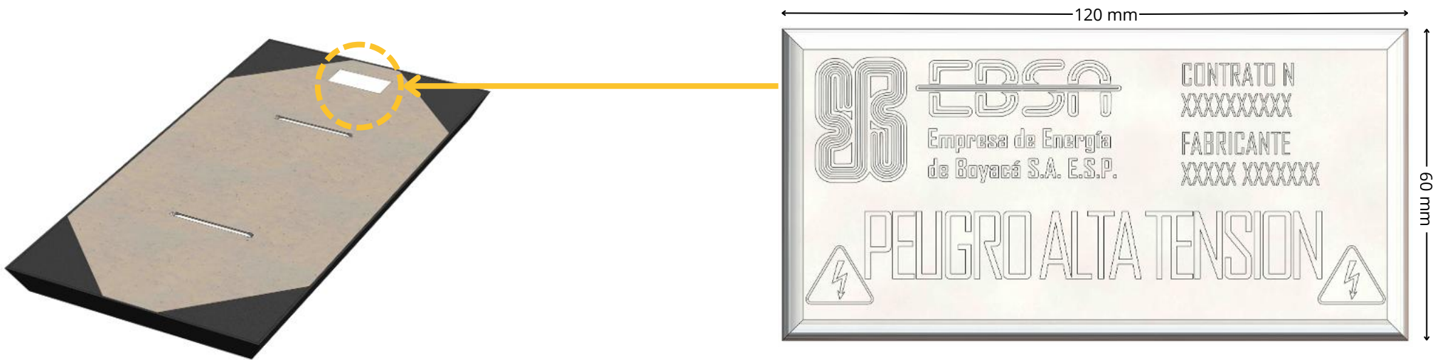
Figura 8. Detalles de placas de advertencia.
