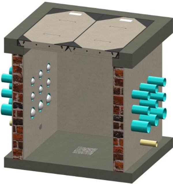
Figura 32. Caja de Inspección Sencilla para Media Tensión 13.2 kV CD-2014.
