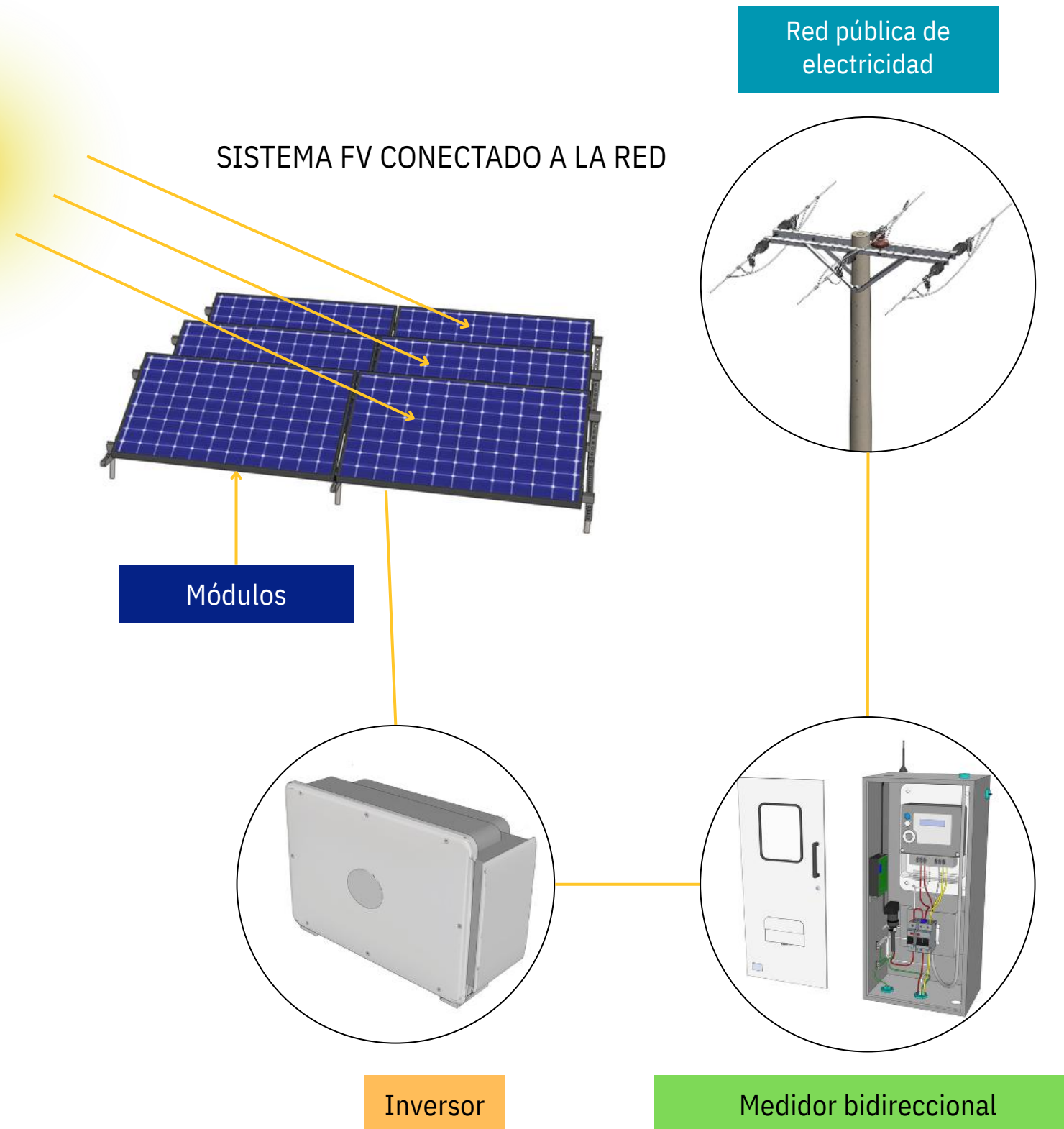
Figura 1. Sistema fotovoltaico conectado a la red
