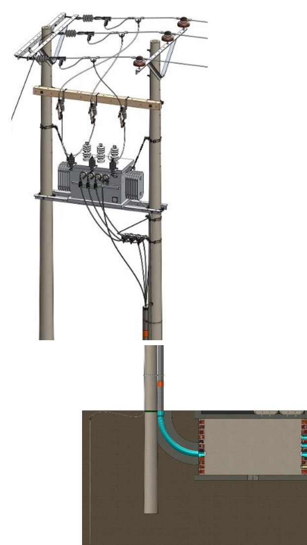
Figura 38. Transición red baja tensión aéreo - subterráneo desde bornes de transformador con estructura en H TR-2007.
