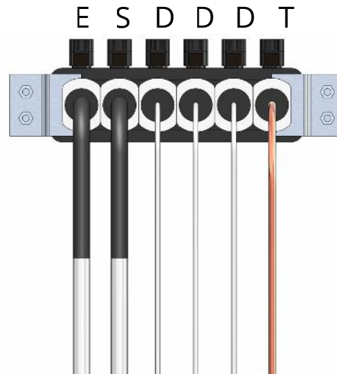
Figura 4. Configuración barraje de neutro en baja tensión.
