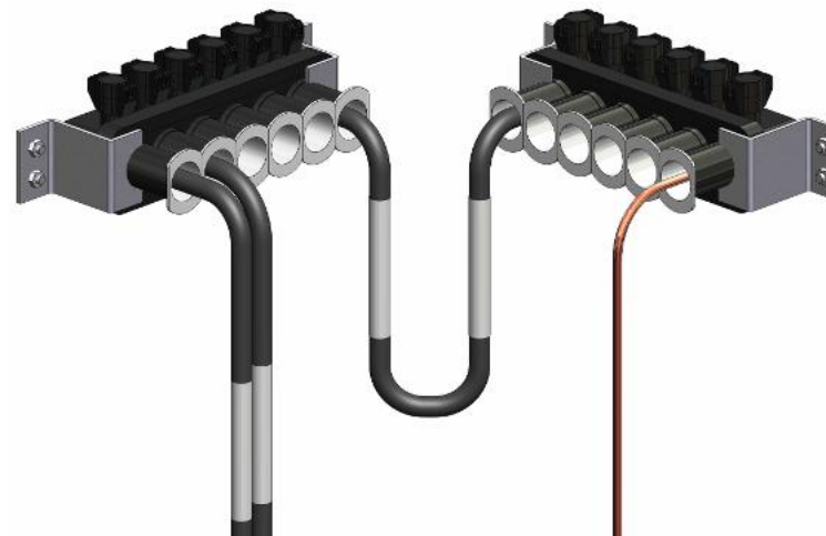
Figura 6. Alternativa de construcción con doble barraje en cajas de inspección.
