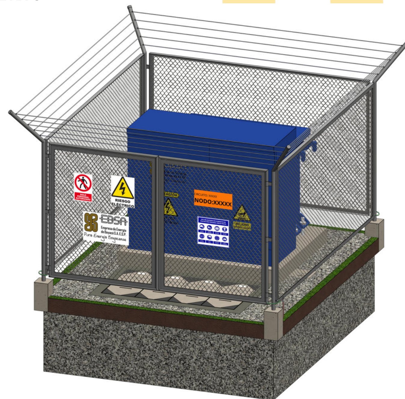
Figura 13. Encerramiento para transformador tipo pedestal.
