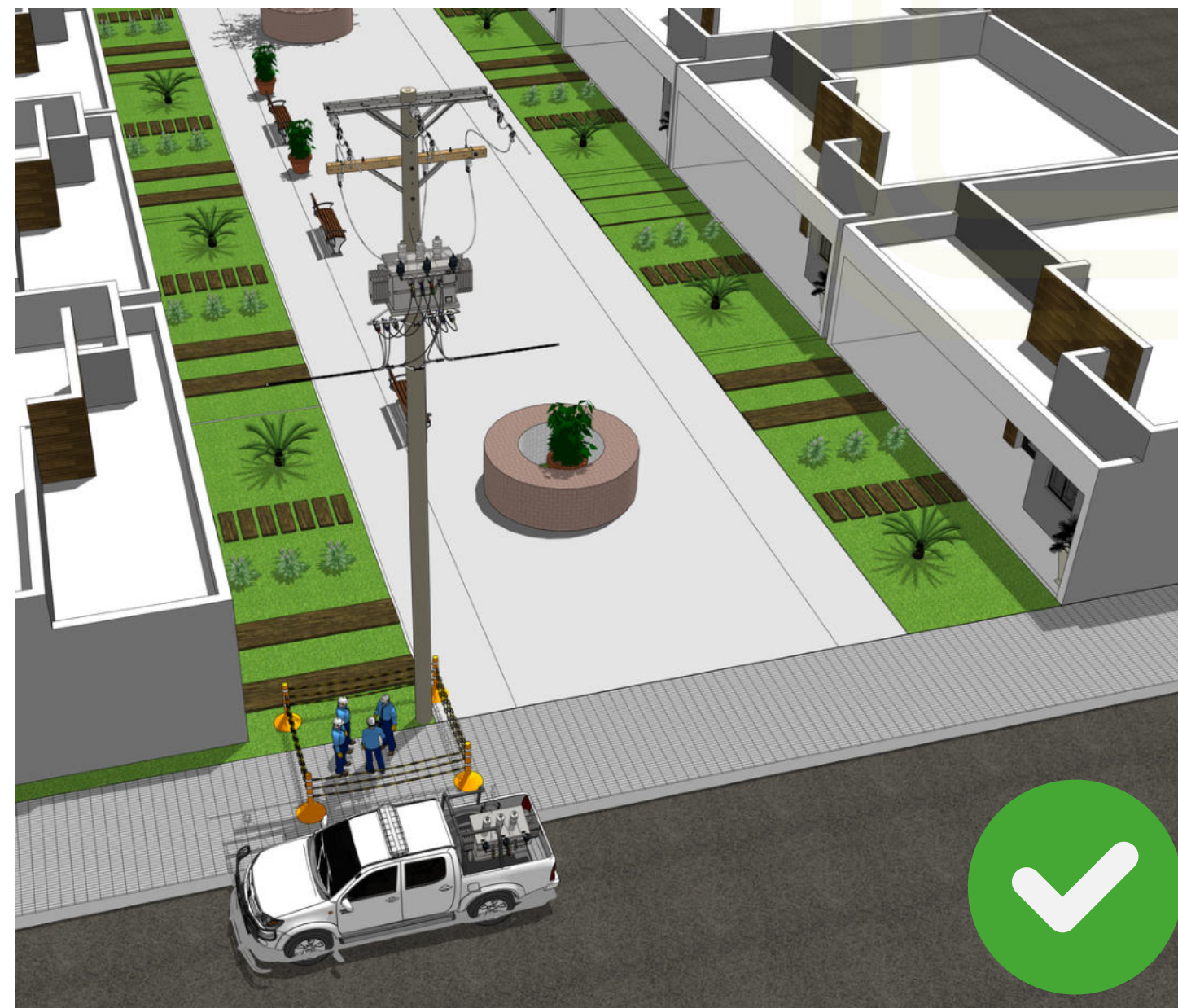
Figura 9. Ubicación adecuada del transformador: optimización del espacio peatonal, seguridad operativa y libre circulación del espacio público.
