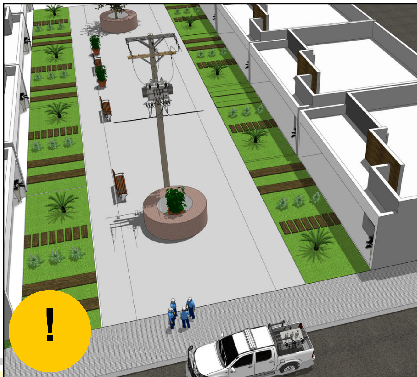
Figura 8. Transformador mal ubicado: dificultad en accesibilidad, inseguridad operativa y cruce de peatones
