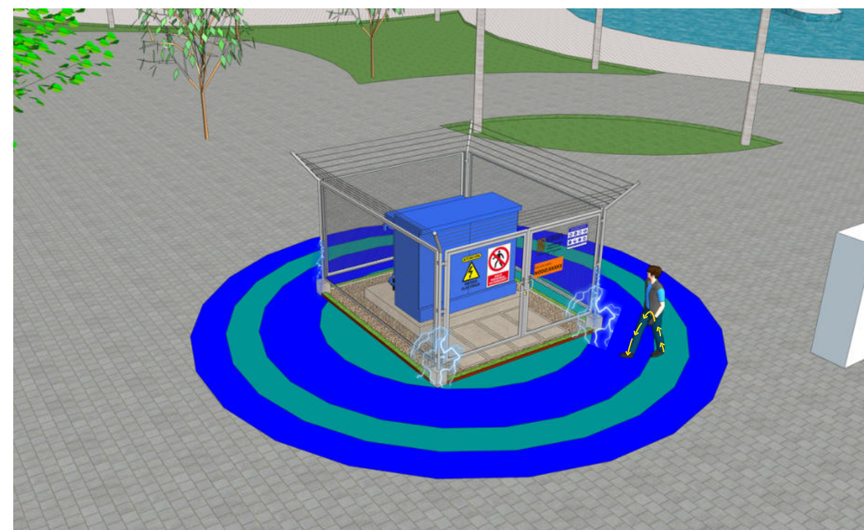
Figura 5. Ilustración tensión de paso..
