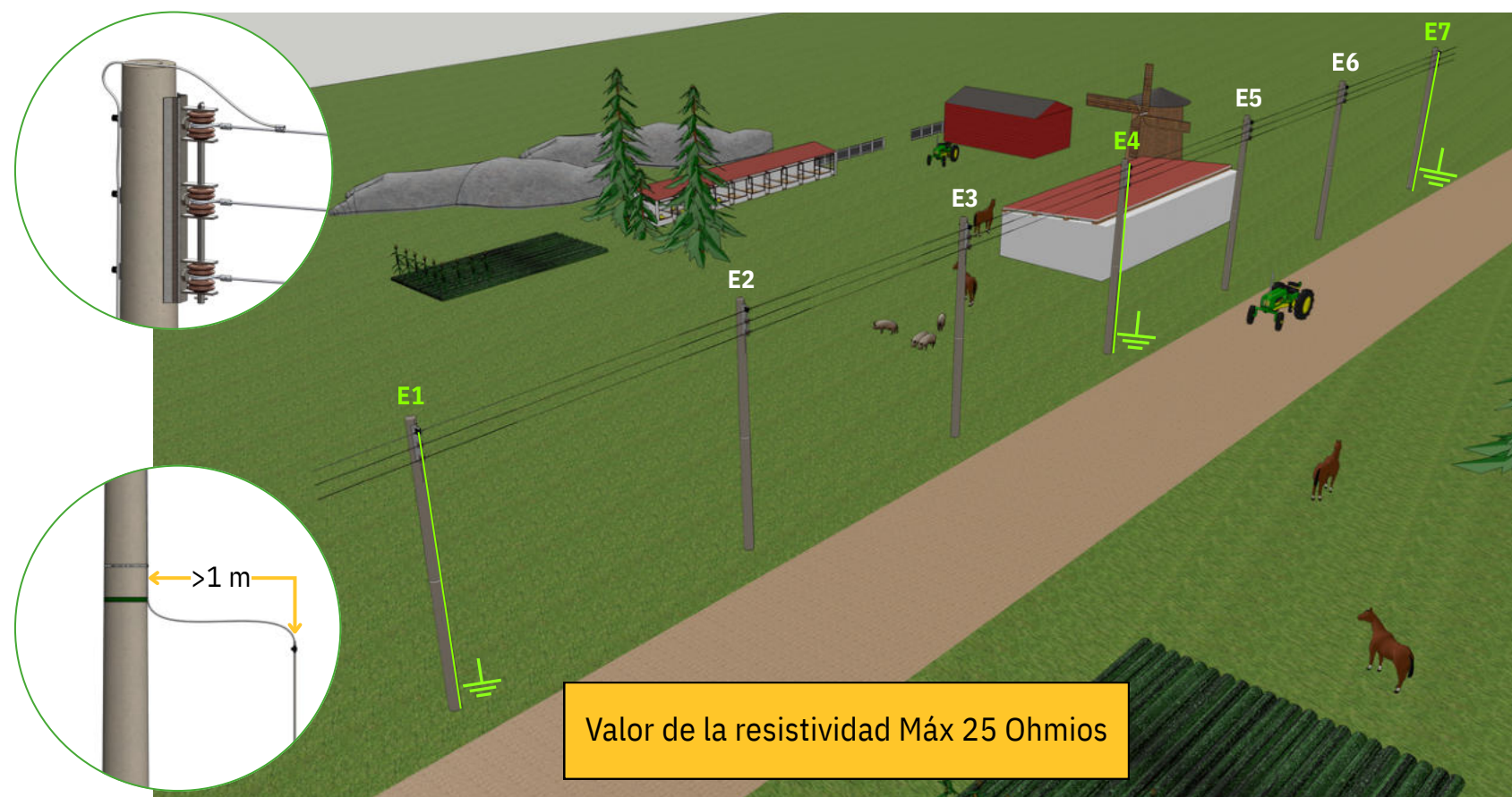
Figura 17. Aterrizaje cada tres estructuras de redes abiertas en baja tensión.
