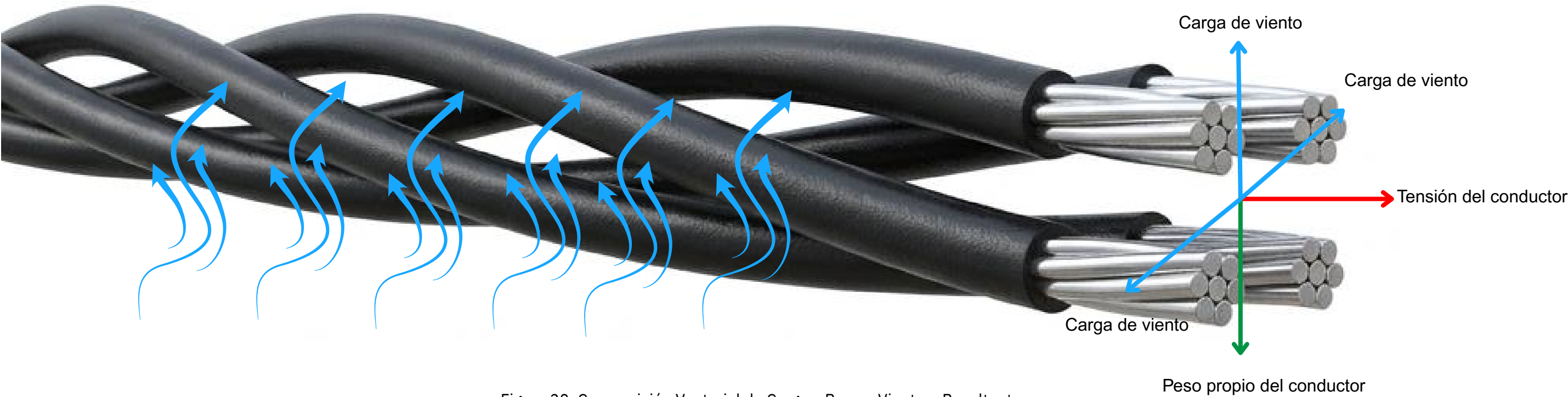
Figura 30. Composición Vectorial de Cargas: Peso + Viento = Resultante.
