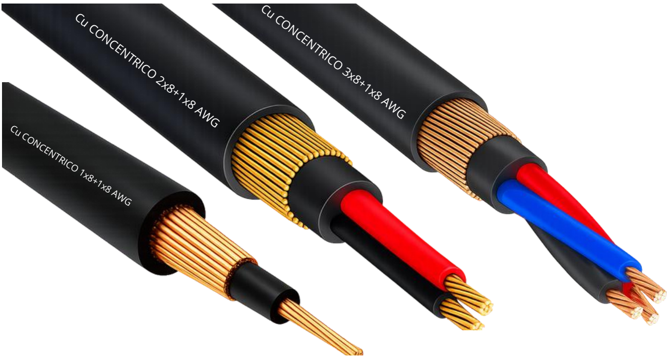
Figura 8. Cable concéntrico de cobre para acometida (desde red secundaria hacia equipos de conexión, o de medida o interruptor de servicio).
