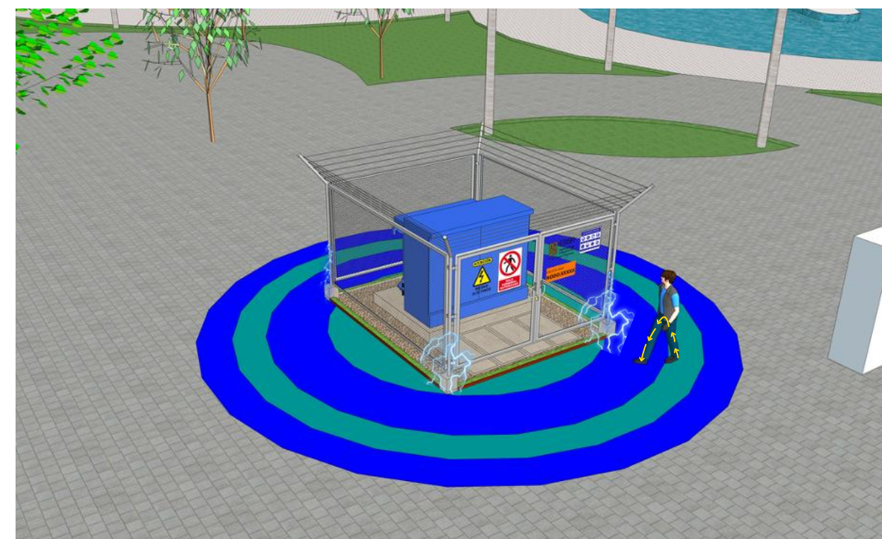
Figura 5. Ilustración tensión de paso.
