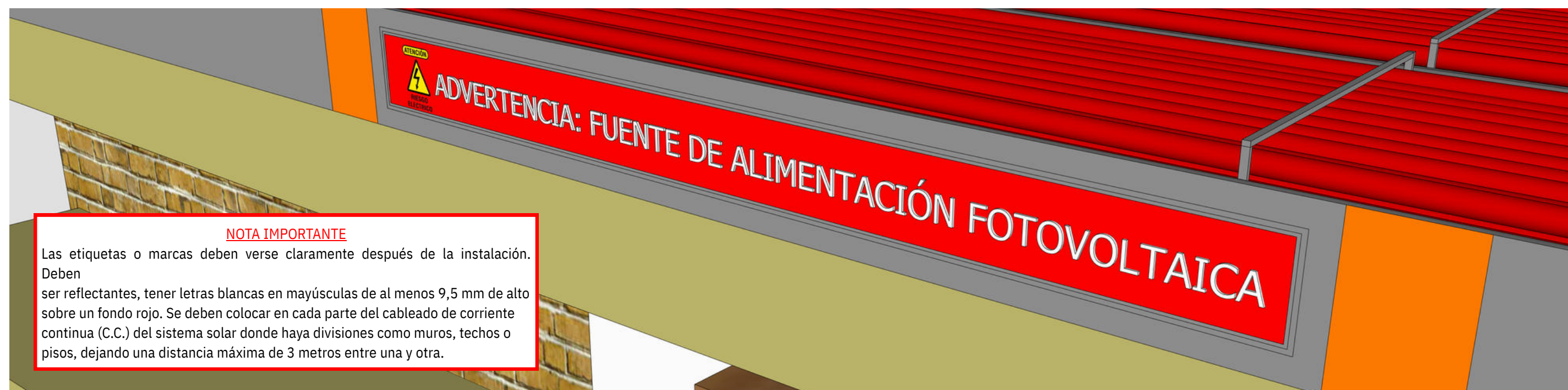
Figura 30. Marcado y etiquetado de fuente de alimentación fotovoltaica: advertencia en cables de corriente continua
