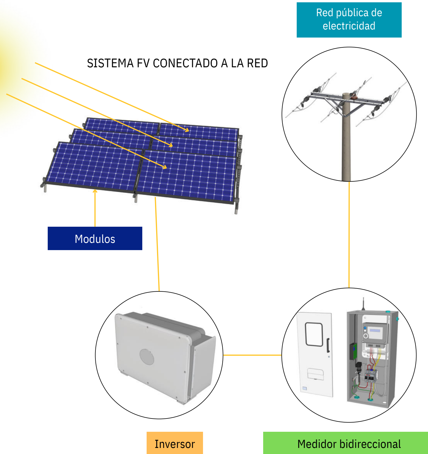
Figura 1. Sistema fotovoltaico conectado a la red
