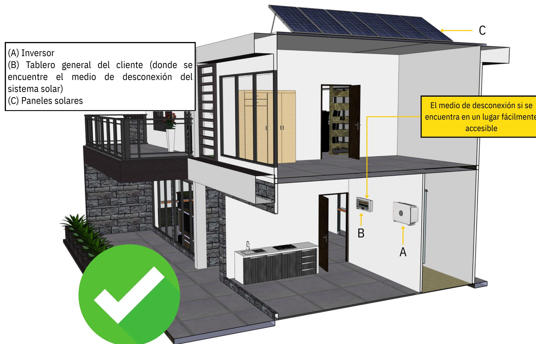
Figura 24. Ubicación conforme del medio de desconexión del sistema fotovoltaico respecto al inversor
