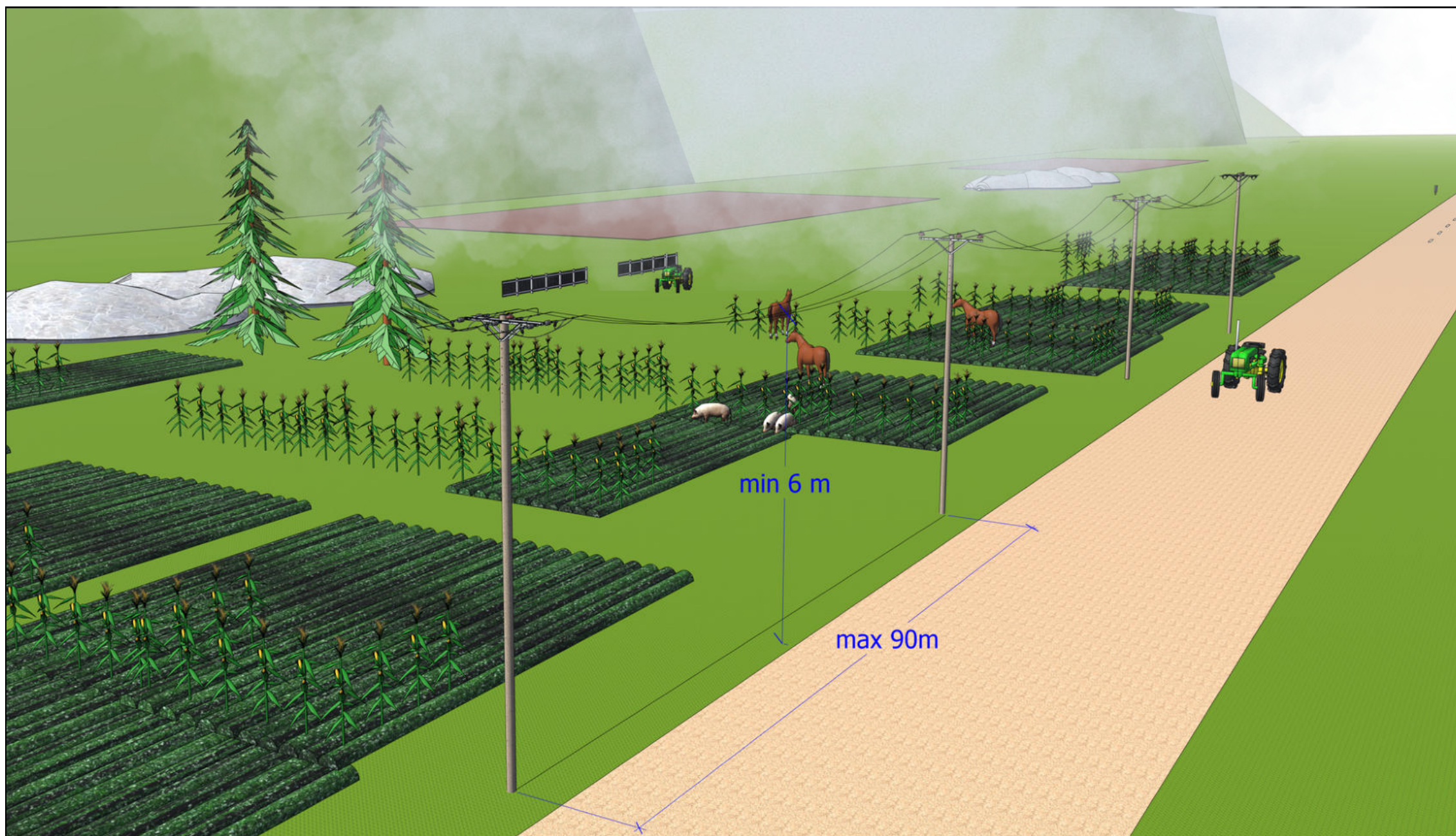
Figura 1. Vista General de una Red Aérea de Media Tensión en el sector Rural
