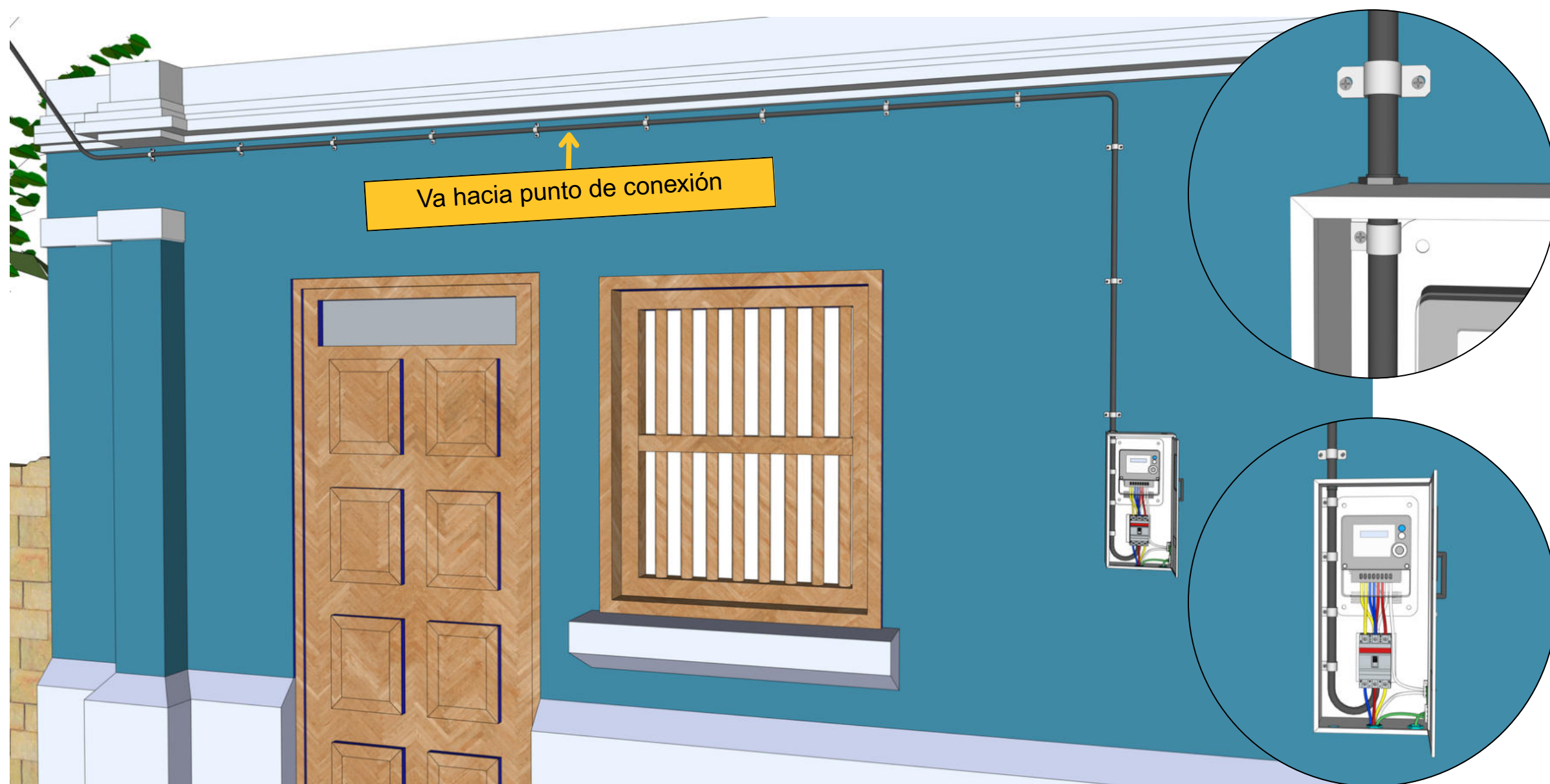
Figura 5. Instalación de acometida con cable concéntrico antifraude sobrepuesto en fachada.
