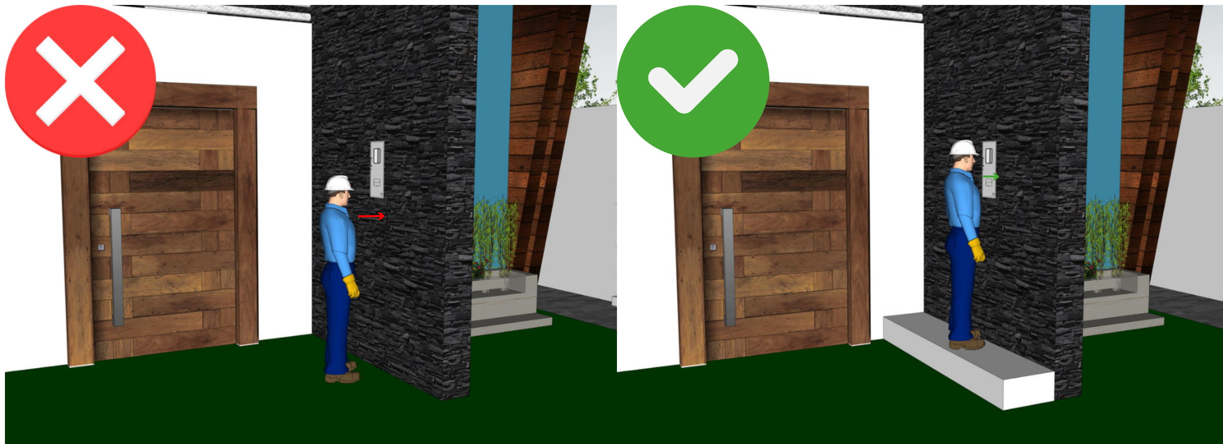
Figura 13. Condiciones de accesibilidad para la lectura de medidores instalados a alturas no estándar.
